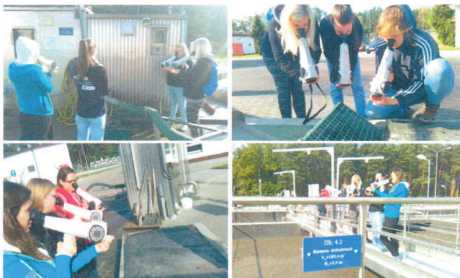
Rysunek 44. Rozpoznanie źródeł emisji z zastosowaniem olfaktometru terenowego Nasal Ranger
