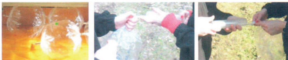
Rysunek 25. Wstępne rozcieńczanie próbki z użyciem szklanych strzykawek [zdjęcia: PZJP]
