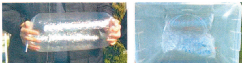
Rysunek 19. Próbkę zanieczyszczonego powietrza pobrane w celu oznaczenia stężenia zapachowego [zdjęcia: PZJP]
