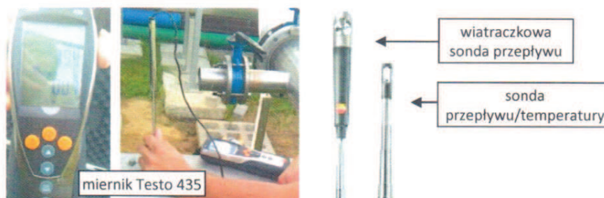
Rysunek 22. Kontrolne pomiary prędkości gazu w punkcie pobierania próbki [zdjęcia: PZJP]
