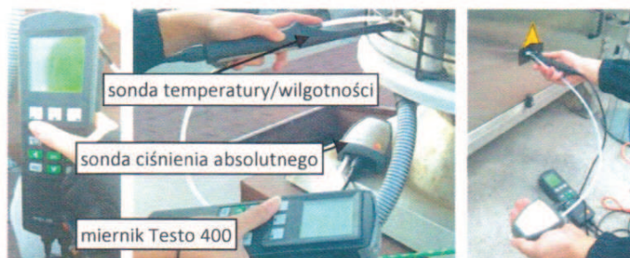
Rysunek 21. Kontrolne pomiary temperatury, wilgotności i ciśnienia gazu w punkcie pobierania próbki [zdjęcia: PZJP]
