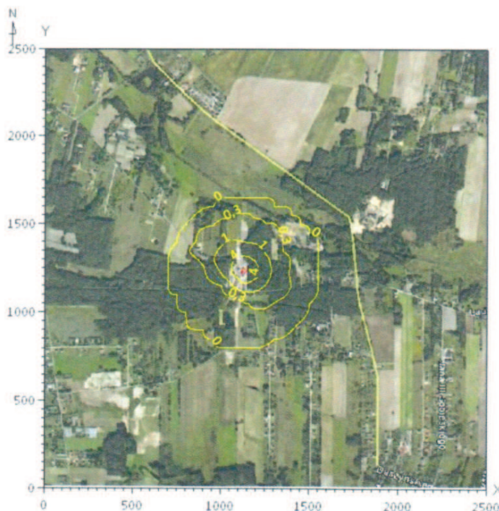
Rysunek 61 a. Izolinie częstości przekroczeń w skali roku środowiskowego progu wyczuwalności zapachu pochodzącego z instalacji dezodoryzującej nr 2 [% czasu roku]
