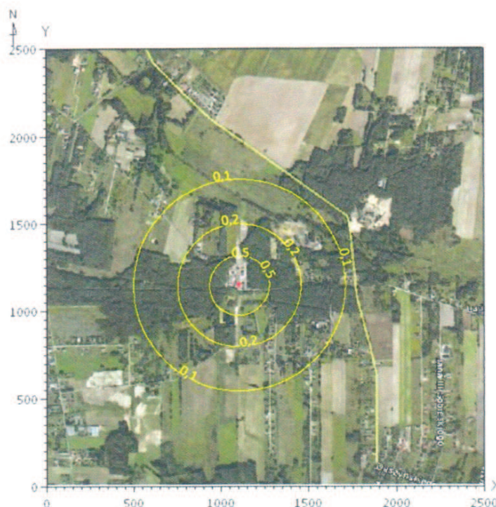
Rysunek 52. Izolinie stężeń maksymalnych ( c_{od,60} [ ou/m^3 ]) zapachu pochodzącego z budynku krat
