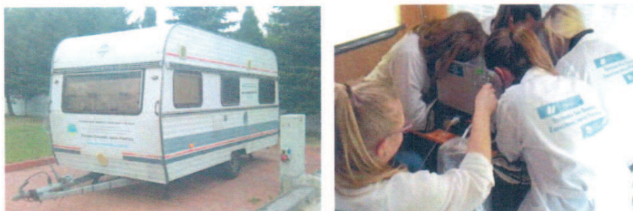
Rysunek 24. Pomiar stężenia zapachowego w mobilnym laboratorium [zdjęcia: PZJP]
