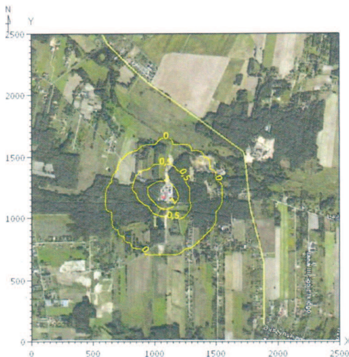
Rysunek 59. Izolinie częstości przekroczeń w skali roku środowiskowego progu wyczuwalności zapachu pochodzącego z instalacji dezodoryzującej nr 1 przy założeniu braku dezodoryzacji w instalacji [% czasu roku]
